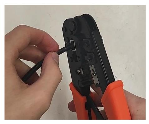
7.Сильно сожмите ручки обжимного инструмента, чтобы зажать провода в коннекторе RJ-45. Вы должны услышать щелчок, когда коннектор RJ-45 будет полностью обжат. Отпустите ручки обжимного инструмента и выньте коннектор RJ-45 из него.
